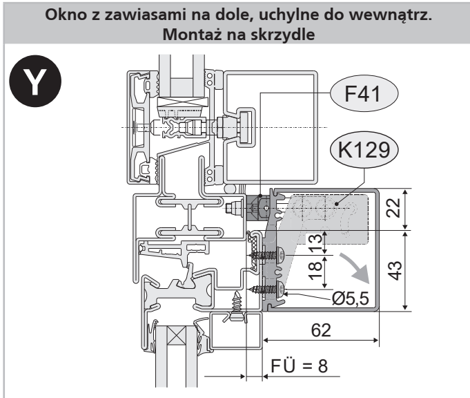
Detal montażu na oknie stalowym
