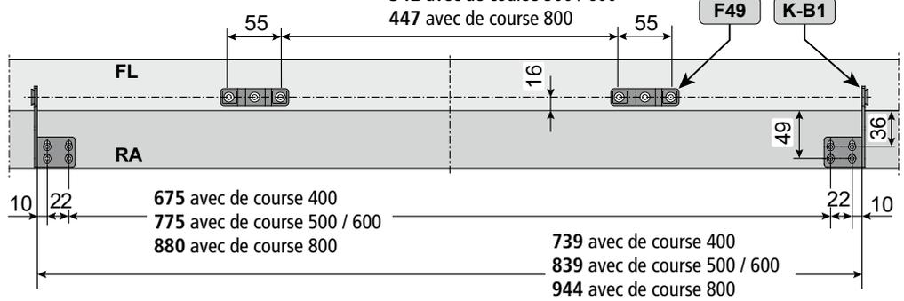
**Schéma de perçage pour consoles K-B1 et support de vantail F49 à la Wiclina 75evo (WICONA)**
