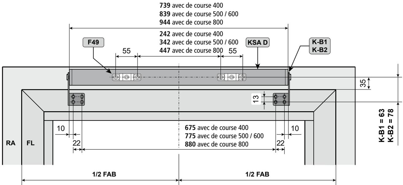
Schéma de perçage pour consoles K-C3 / K-E1 et support de vantail F49
