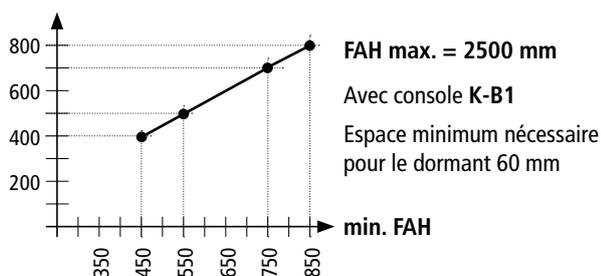
Vantaux battant et Vantaux basculant extérieur
