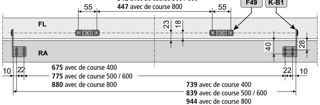
**Schéma de perçage pour consoles K-B1 et support de vantail F38 à la Wing 105D (RAICO)**
