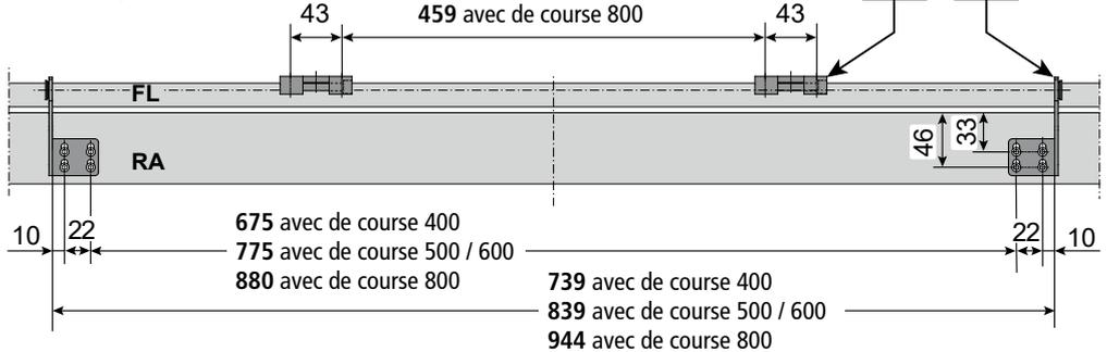
**Schéma de perçage pour consoles K-E1 et support de vantail F16-1 à la AWS 57 RO (SCHÜCO)**
