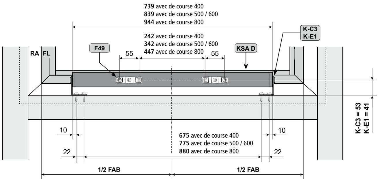
**Schéma de perçage pour consoles K-B1 et support de vantail F49 à la AWS 75.SI (SCHÜCO)**
