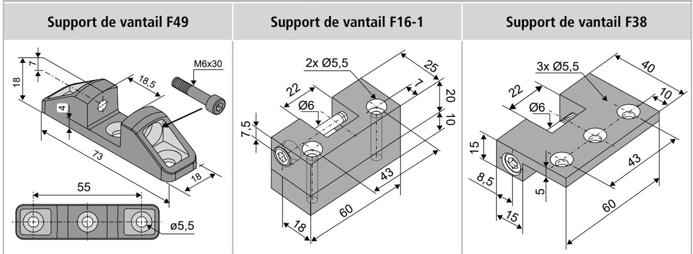
ÉTAPE DE MONTAGE 4: SCHEMA DE PERÇAGE POUR CONSOLE ET SUPPORT DE VANTAIL
