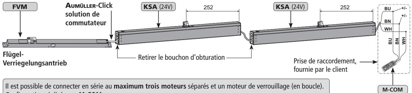
Il est possible de connecter en série au maximum trois moteurs séparés et un moteur de verrouillage (en boucle). Configuration réalisée par M-COM.
