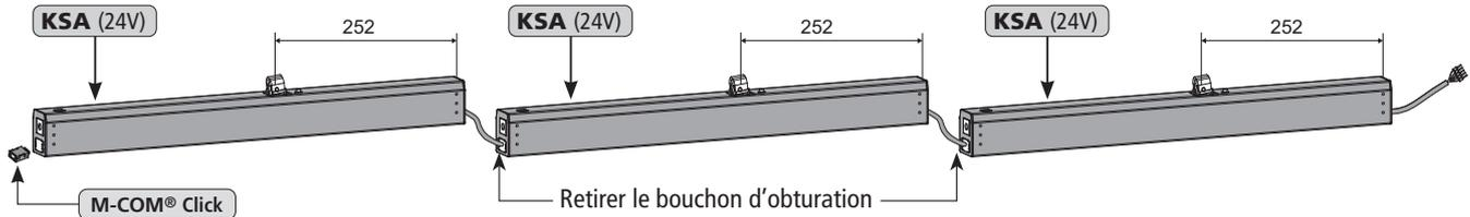
Il est possible de connecter en série au maximum trois moteurs séparés et un moteur de verrouillage (en boucle). Configuration réalisée par M-COM® Click.
