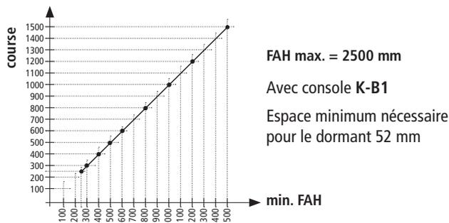
Vantaux battant et Vantaux basculant extérieur
