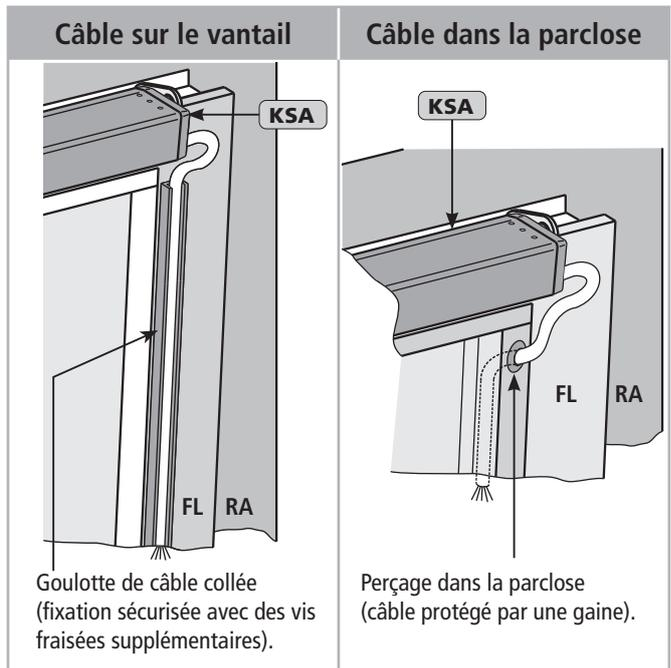
**Positionnement du câble de raccordement sur le vantail:**
