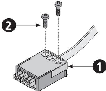
**REMARQUE** Les crochets à crans sur le couvercle du boîtier ① empêchent un enlèvement de la prise sous traction.
